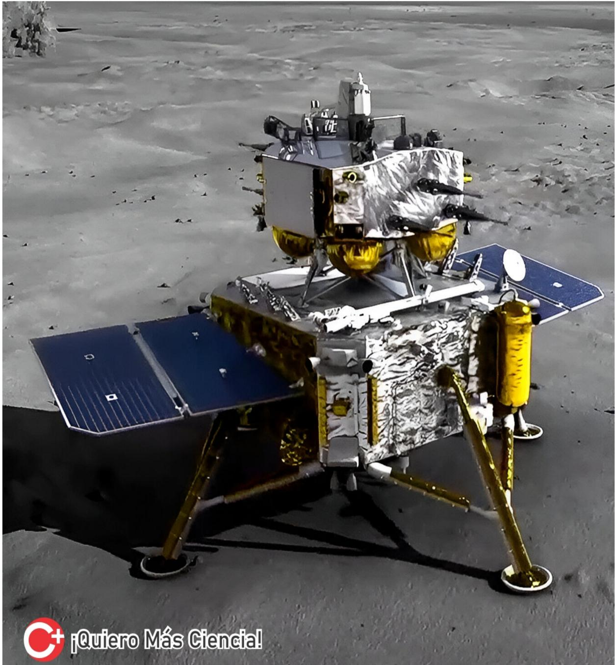
Representación del módulo de aterrizaje Chang'e 5 de China tras su aterrizaje en la Luna. La nave está dotada de un taladro para extracción de núcleos, un brazo robótico y un vehículo de ascenso, diseñados para recolectar y retornar muestras lunares.
