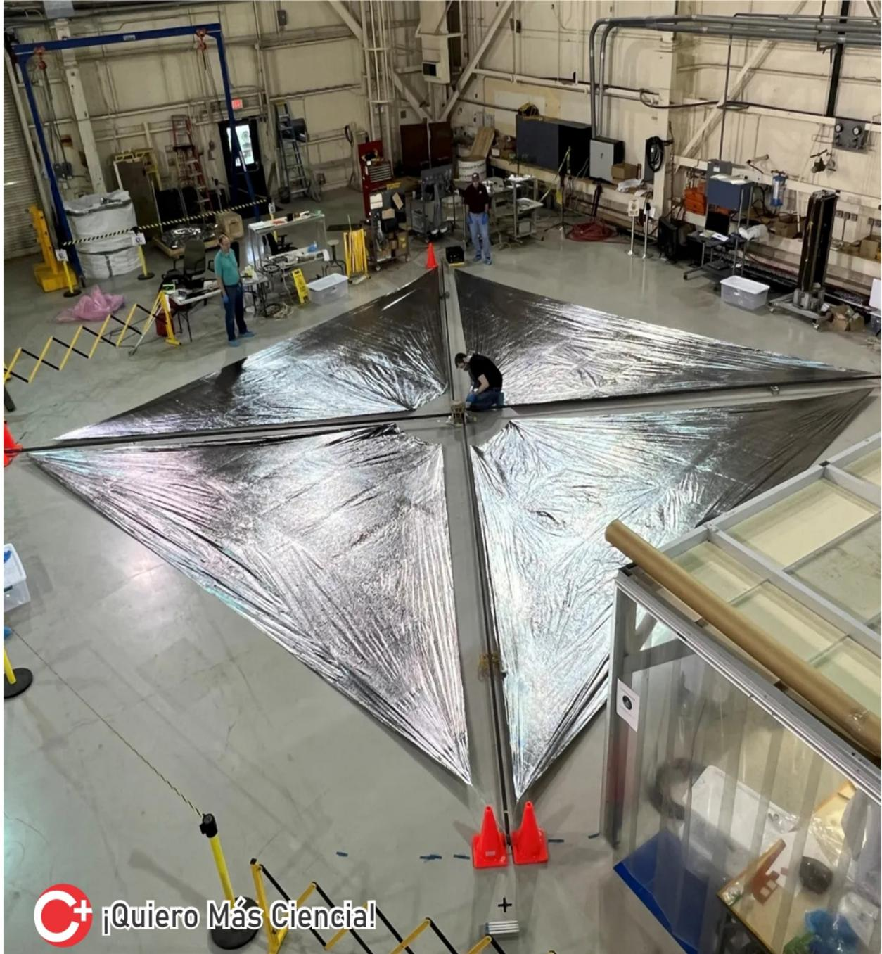
Los ingenieros del Centro de Investigación Langley de la NASA están probando el despliegue de la vela solar del Sistema de Vela Solar Compuesta Avanzada. La vela solar, una vez desplegada, mide aproximadamente 9 metros por lado. Debido a que la presión de la radiación solar es débil, la vela debe ser de gran tamaño para producir un empuje eficiente.
