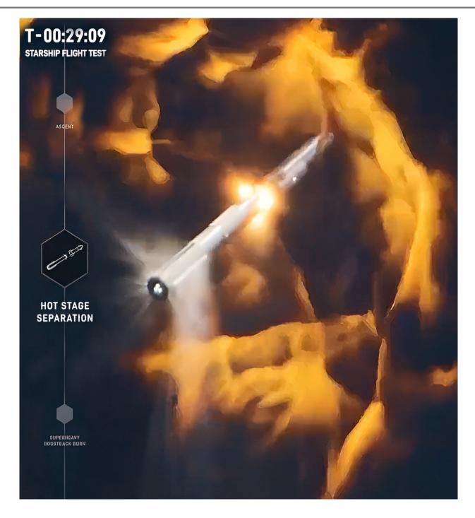
Maniobra de Separación en Caliente: La separación de etapas en caliente utiliza tres motores de la etapa superior (la nave espacial Starship) para empujar el cohete principal. Después de separarse, Starship arrancó de nuevo sus motores para seguir ascendiendo.
