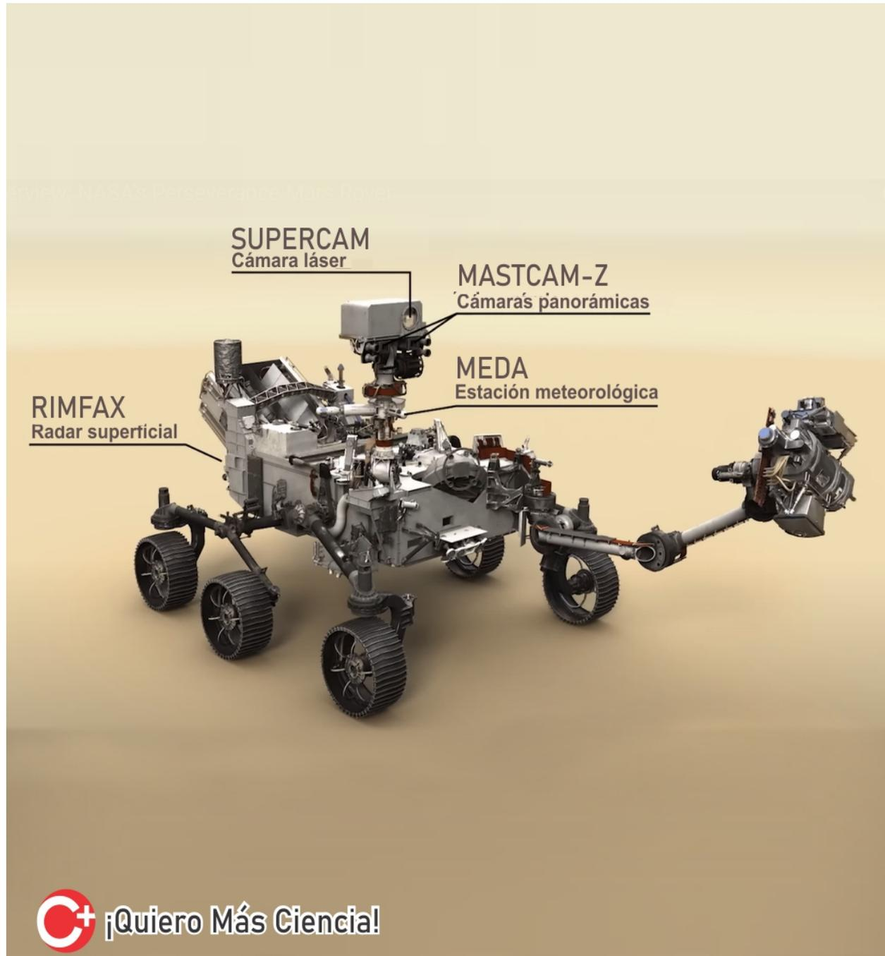
El robot Perseverance está equipado con cuatro instrumentos y uno de ellos, la MASTCAM-Z permite obtener imágenes panorámicas de alta resolución.
